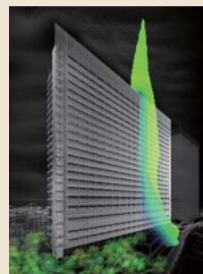
3Dシミュレーションソフトによる周辺空気温度の解析結果
